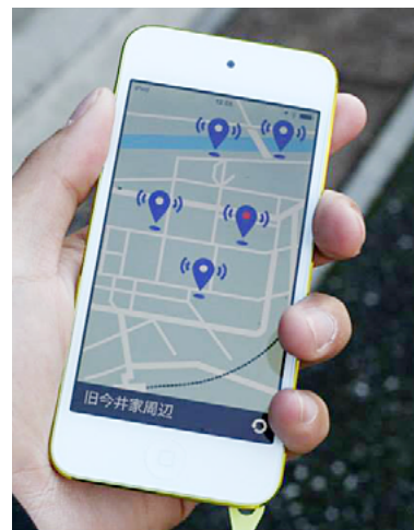
試作アプリ：ビーコンを設置した観光スポットに近づく、iPod touchでテキストと音声で観光案内の説明を提示
