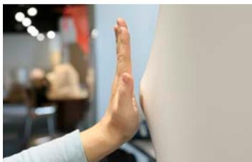
「Hello Wall」はキャッチとタッチふたつの機能を実装。壁に手を近づけると壁が変形しタッチしてくる様子。
