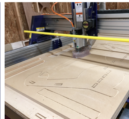
カメ椅子の部品を大型の切削加工機「ShopBot」で加工中している様子
