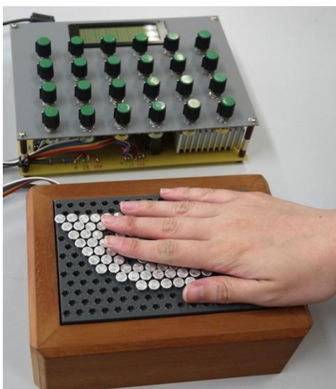
図 3 温感触図 2 号機の全体像
