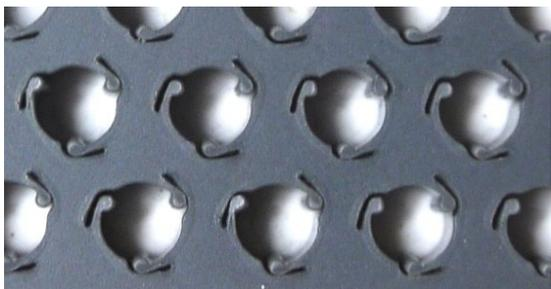
図 5 ピンをはめ込む穴の形状
