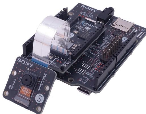
Spresense は、ソニーの低消費電力の IoT 向けスマートセンシングプロセッサ「CXD5602」を搭載したコンパクトな開発ボードです。「Arduino IDE」を使って、個人でも容易に IoT アプリケーションの開発ができるだけでなく、組み込み開発者向けに「Eclipse IDE」を使った「NuttX」ベースの SDK にも対応、幅広いアプリケーションの開発をサポートします。
