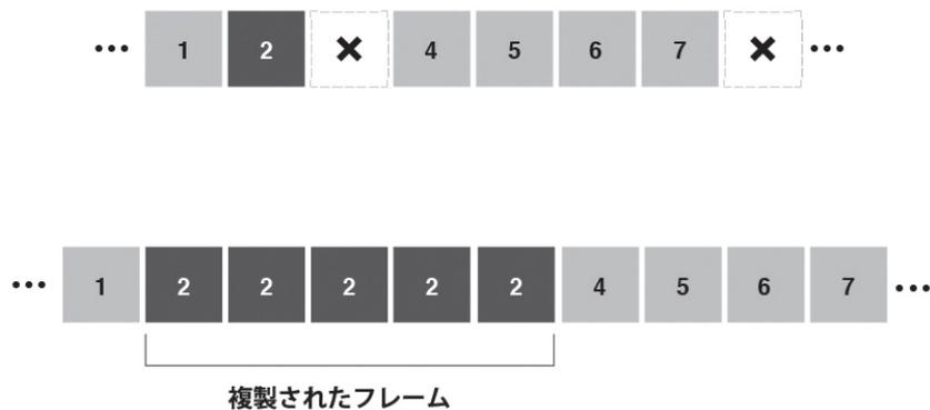
図4. 差分フレームの複製 (イメージ図)
