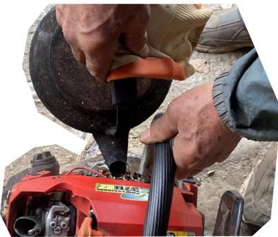
**3** 軸を抜くためにあらゆる方法を試す。ヤカンで沸かしたお湯をかける。熱で変形して緩むことを狙っているようだ。知恵を与えれば、ヤカンのお湯も立派な道具になる。
