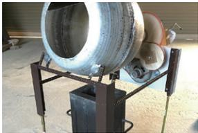
廃材を利用したヤーコン茶焙煎機(回転式攪拌器)と熱源としてのロケットストーブ
