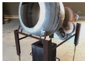
廃材を利用したヤーコン茶焙煎機（回転式攪拌器）と熱源としてのロケットストーブ
