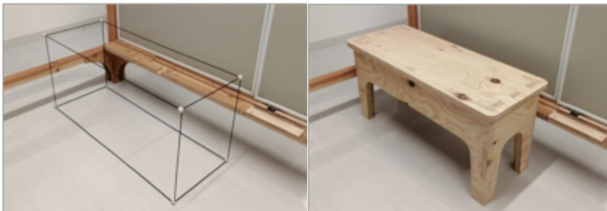
空間ボリューム検討ツール(左:ロッドとコネクタを用いたボリューム検討の様子、右:ボリューム検討後に実際に制作した家具)
